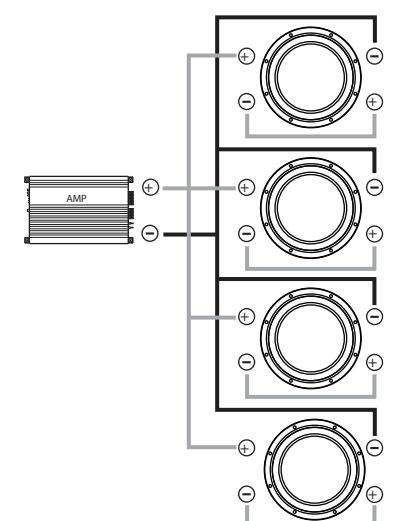
**With coils wired in series and speakers wired in parallel** (Con rollos alambró en la serie y oradores alambró en paralela, Avec les bobines télégraphiées dans le feuilleton et les haut-parleurs a analogie, Mit Windungen die in serie verdrahtet werden, und Sprecher haben parallel verdrahtet):
