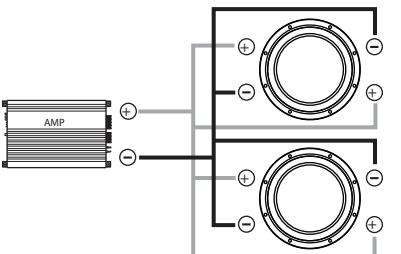
**With coils and speakers wired in parallel** (Con rollos y oradores alambró en la paralela, Avec les bobines et les haut-parleurs à télégraphiées dans l'analogie, Mit Windungen und Sprecher haben parallel verdrahtet):
